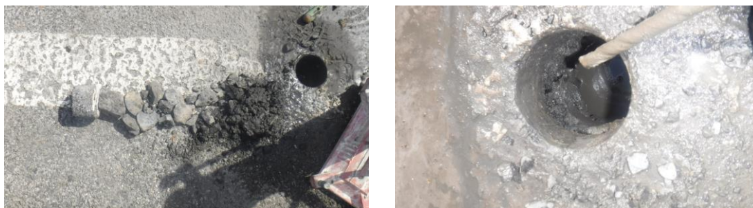
Obr. 27 a 28 – Sondy do vozovky
